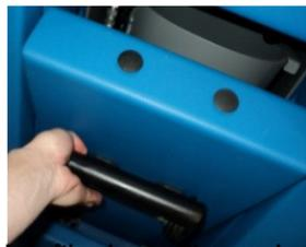
**ÉTAPE 3 :** Ouvrez le boîtier de remplissage du compartiment en appuyant sur la poignée vers le bas. Tirez sur la porte de confinement et laissez-la pivoter jusqu'à la position ouverte.
