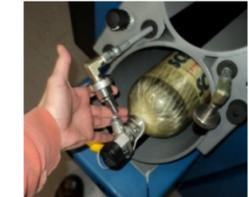
**ÉTAPE 4 :** Glissez l'appareil respiratoire autonome dans **ÉTAPE 5 :** Fixez le tuyau de remplissage. 1 ou 2 bouteilles peuvent être remplies à la fois. sur la bouteille ou bouteilles
