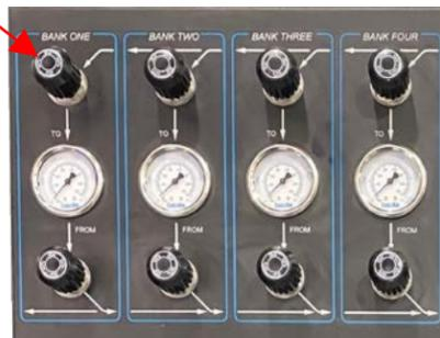
**ÉTAPE 2 :** Ouvrez l'une des vannes « FROM » du panneau en cascade pour assurer l'alimentation. air vers le détendeur SCBA/SCUBA. Réglez le détendeur à la pression de remplissage souhaitée pour la ou les bouteilles SCBA à remplir. (**Remarque :** cette étape fournit également de l'air au détendeur d'air pilote, nécessaire au bon fonctionnement de la porte de confinement de la station de remplissage).
