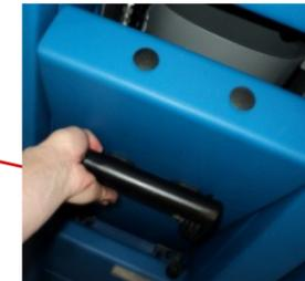
**ÉTAPE 8 :** Fermez la porte de l'enceinte de remplissage en cliquant sur la poignée et en tournant la porte à la verticale.
